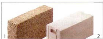
1. Vollstein aus Leichtbeton, Vollstein aus Blähstein 2. Porenbeton
