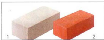
1. Kalksand-Vollstein 2. Vollziegel (auch als Backstein oder Klinker bekannt)
